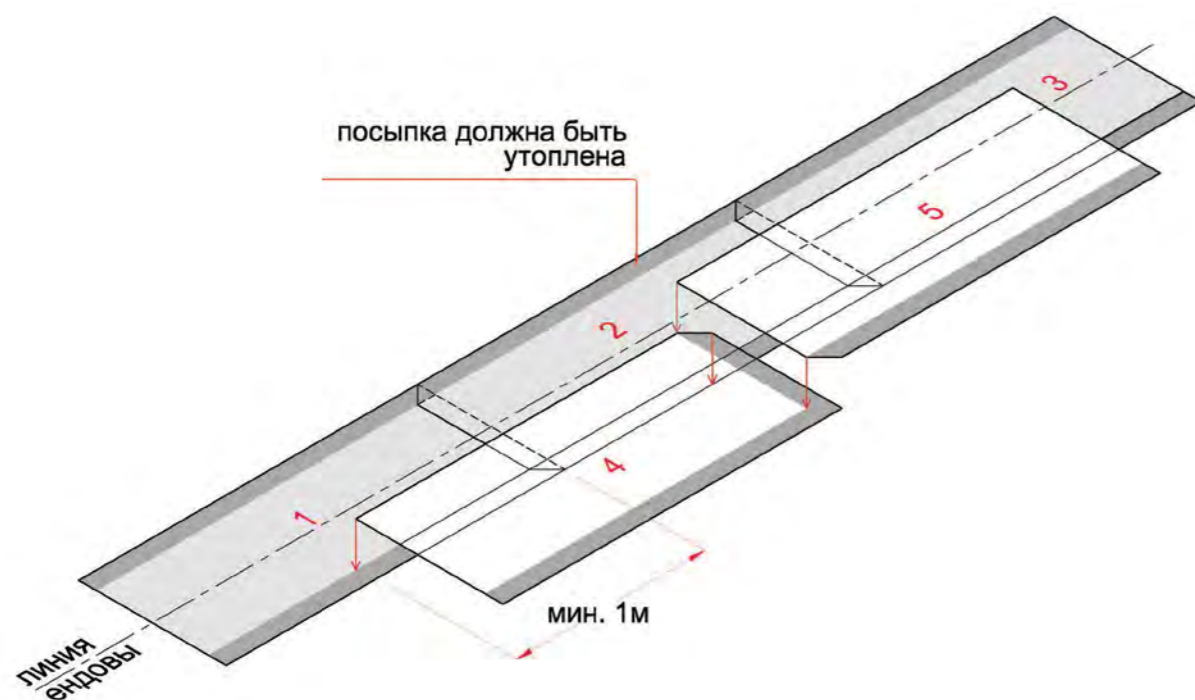
Рис. 8 Укладка рулонов основного слоя
